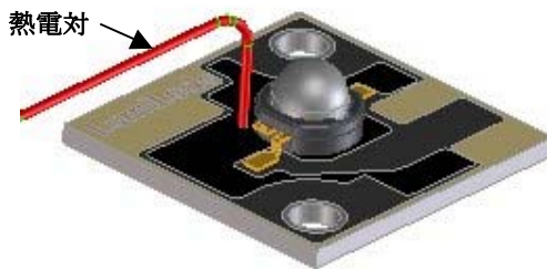
図 10. T 基板 を監視する熱電対の位置
